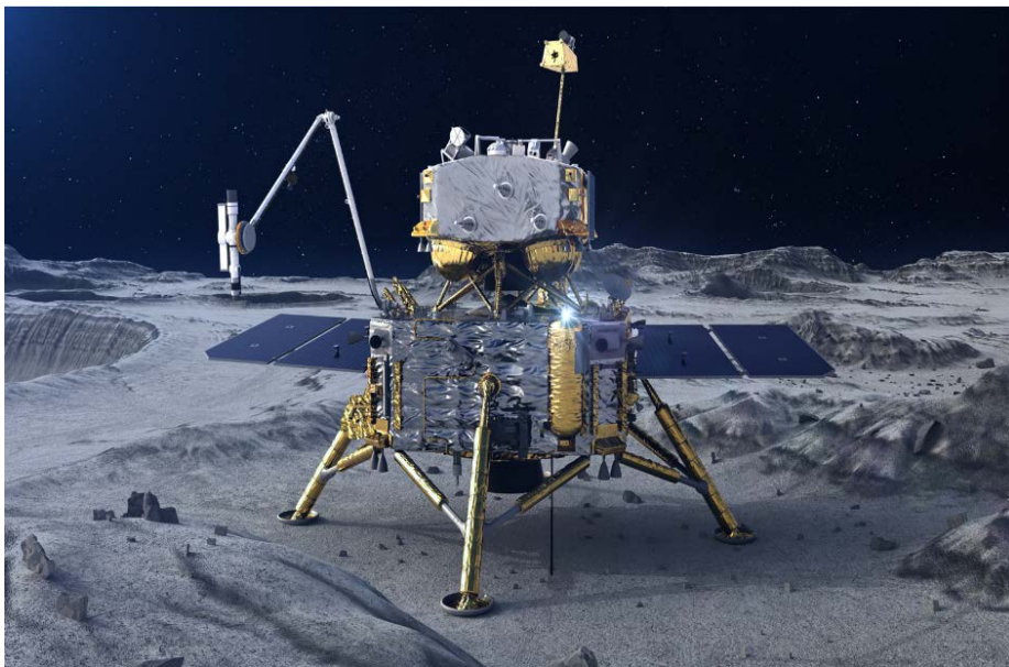
附圖五 「嫦娥五號」的上升器與著陸器著陸月球後，在月面採樣作業示意圖。(圖源：國家航天局)
