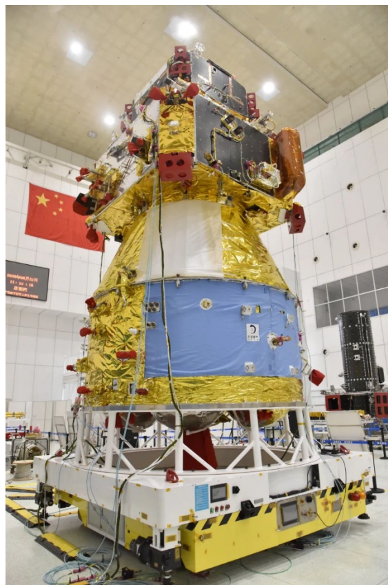
附圖三 4項主件整合而成的嫦娥五號探測器（白色支架座上方）通過測試，即將裝入運載火箭頂端的整流罩內，擇機發射。(圖源：中國航太科技集團)
