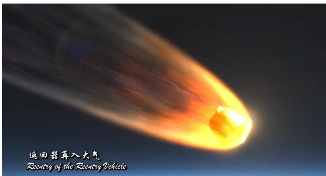
附圖十 嫦娥五號返回器高速進入大氣層持續下降，與空氣摩擦使返回器表面產生極高的溫度，本圖為返回器再入大氣模擬圖。（圖片來源：國家航天局）
