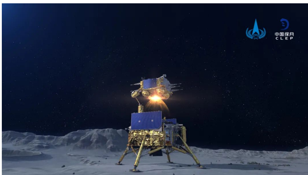
附圖六 上升器在月面完成採樣與封裝後，自上升器發射升空的瞬間。（圖源：月球探測工程中心）
